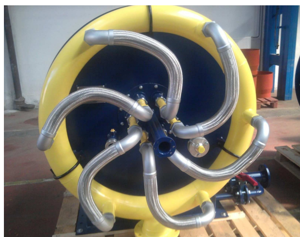
Obr. 4 Nízkoemisní výkonový hořák
