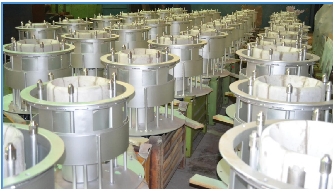
Obr. 1 – Ukázka ústí procesních hořáků určených do procesu krakování ropy (tepelný rozklad uhlovodíků).
