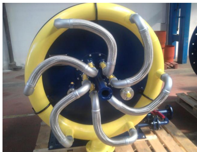
Рис. 4 Низкоэмиссионная мощная горелка
