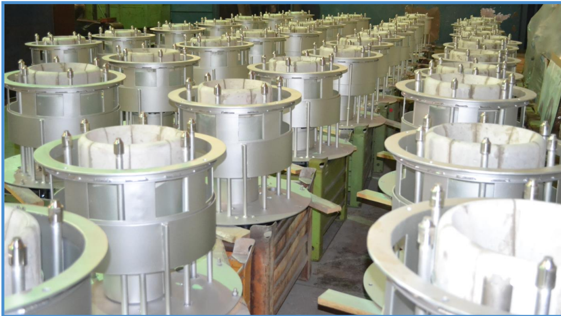
Рис. 1 - Образец устья технологических горелок, предназначенных для процесса крекинга нефти (термического разложения углеводородов).
